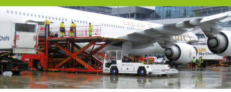
Die CARGO MASTER TRANSPORTER CMT 7 sind speziell für den Transport schwerer und sensibler Luftfracht konzipiert. Als Bindeglied zwischen Cargo Lader und Dolly Train steigern sie auf den großen internationalen Flughäfen die Abfertigungsleistung erheblich.
